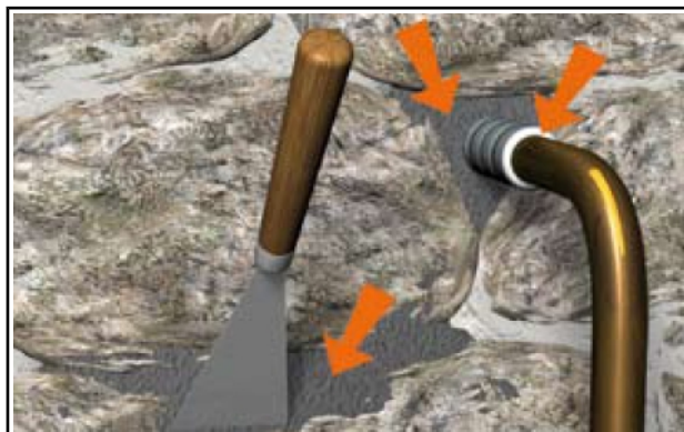
Situation après travaux de colmatage
