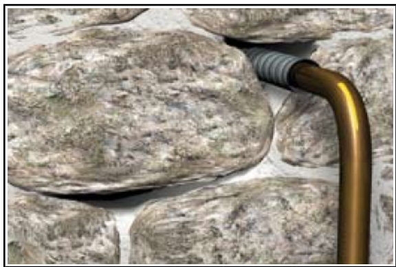
Situation initiale avant colmatage
