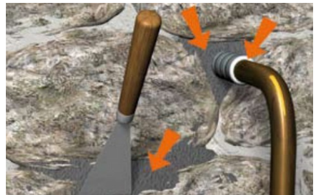
Situation après travaux de colmatage
