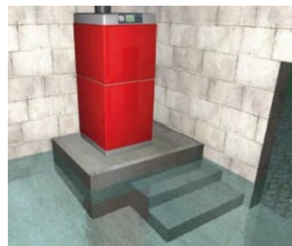
Mise hors d'eau par surélévation
