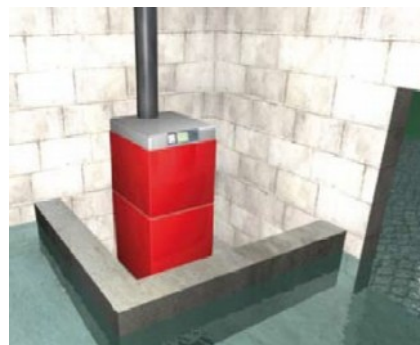
protection par disposition étanche
