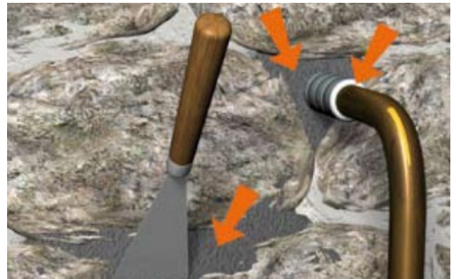
Situation après travaux de colmatage
