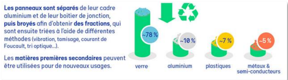
Figure 6 : Procédure de recyclage des panneaux (source : SOREN)
